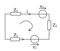
$$\boxed{ \underline{I} = \frac{\displaystyle\sum_{k} \epsilon_{k} \, \underline{E_{k}}}{\displaystyle\sum_{k} \underline{Z_{k}}} } \text{ avec } \epsilon_{k} = +1 \text{ pour } e_{k} \text{ dans le sens de i, -1 dans le cas contraire.}$$
