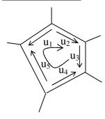
$$\begin{split} &u_{_k}=u_{_k}(t)=U_{_k}.\sqrt{2}.cos(\omega.t+\varphi_{_k}) \text{ avec } u_k \text{ représenté par } \underline{u_{_k}}(t)=U_{_k}.\sqrt{2}.e^{j(\omega.t+\varphi_{_k})}\\ &=\underline{U}_{_k}.\sqrt{2}.e^{j.\omega.t} \quad \underline{U}_{_k}=U_{_k}.e^{j\varphi_{_k}} \end{split}$$
